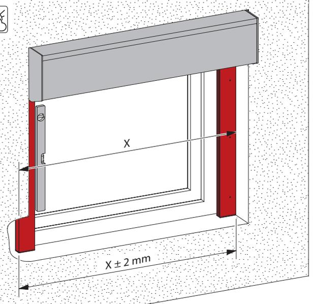
Bei Rollladen-Systemen mit integriertem Fliegenschutz darf die Elementbreite unten an den Führungsschienen nicht mehr als +/- 2 mm abweichen.
